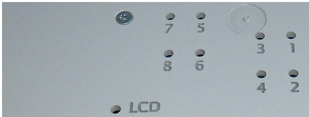
Die Potentiometer erreichen Sie über Bohrungen mit einem sehr schmalen Flachkopfschraubendreher, die entsprechend der CV Ausgänge von 1 bis 8 durchnummeriert sind.
